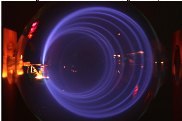
Abb. 2 Fadenstrahlen im Fadenstrahlrohr bei verschiedenen Magnetfeldstärken
