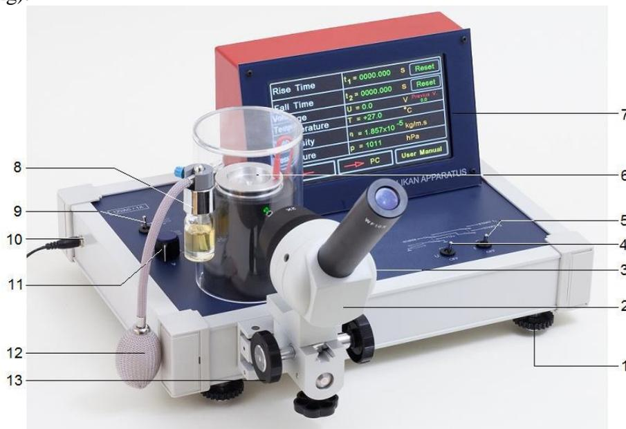
**Abb. 4** Verwendeter Millikan-Apparat von 3B SCIENTIFIC® und seine Bestandteile
