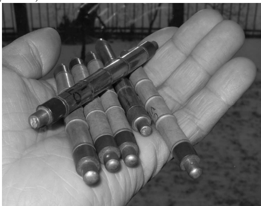
Abb. 3 Geiger-Müller-Zählrohre vom Typ CTC-5 und Zählrohrkennlinie (schematisch)
