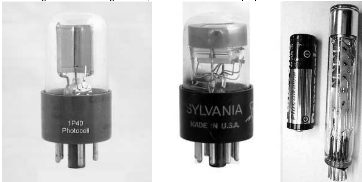
Abb. 1 Photozelle, Vakuum-Photodiode und Photo-SEV
